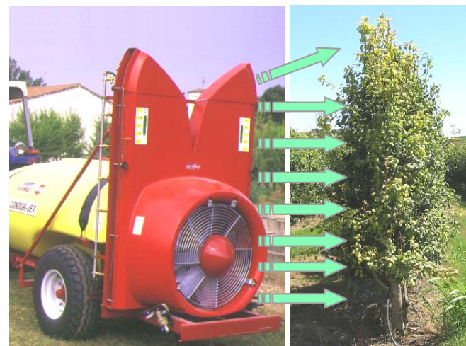
Equip amb deflectors amb alta adaptació a la geometria del cultiu. Increment de la deposició en zones interiors altes i menor risc de pèrdues per deriva.
